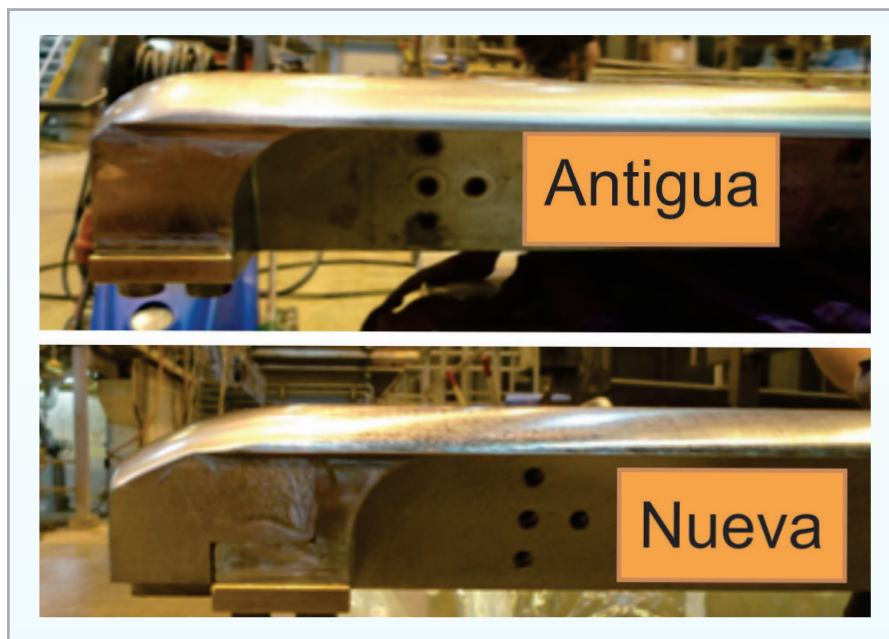
Figura 6: Comparativo entre los chaflanes de la zapata (antes y después de la modificación).
